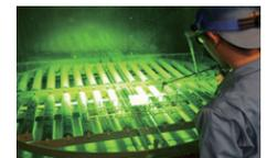
浸透探傷検査設備
